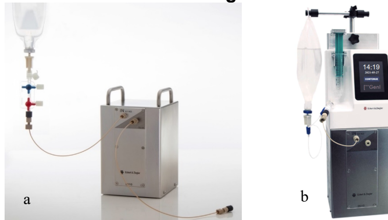
Figur 1: a. GalliPharm generator, uppställning för manuell eluering. b. GalliPharm generator med installerad EluGen pump.
