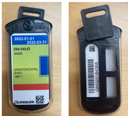
Figur 6: Fram och baksida på areadosimetrar som placeras på c-bågar och på alla fasta genomlysningsutrustningar.
